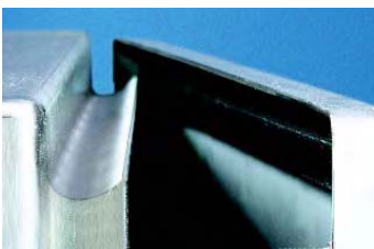
Gouttière avant double épaisseur de tôle empêchant la pénétration de l'eau et de la poussière dans le coffret lors de l'ouverture de la porte.
