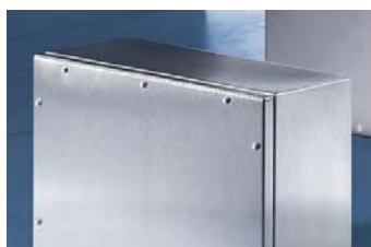
Premium Line KL Résistant au nettoyage haute pression, IP 69K et protection CEM supérieure grâce aux joints d'étanchéité et au contact métallique entre le coffret et le panneau arrière.
